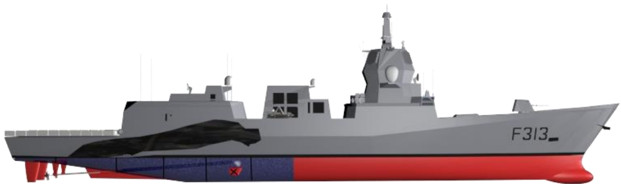
Figura 13 – Alagamento dos compartimentos da fragata
