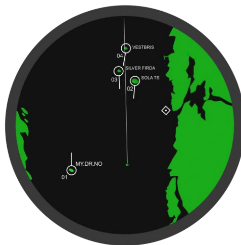
Figura 5 – Tela do radar ARPA integrada ao AIS
